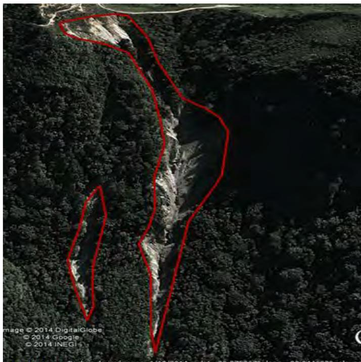
Figura 7. Punto 14. Deslizamiento de ladera ubicado al suroeste de Ozomatlán con coordenadas:  $20^{\circ}16'28.16''N$   $98^{\circ}02'41.68''W$ .
