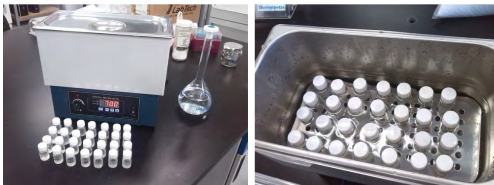
Fig 3.8 Revelado de placas de CR-39 mediante baño maría
